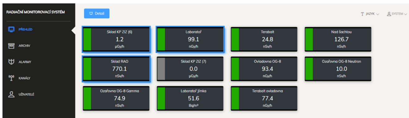
Přehledové tablo okamžitých hodnot z připojených detektorů
